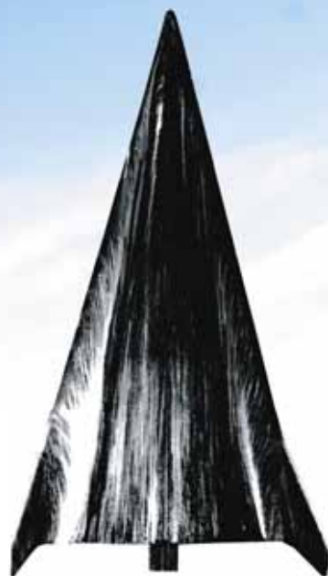
Маслосажеваемая картина линий тока на поверхности модели ELAC 1, полученная в аэродинамической трубе Т-313 Института теоретической и прикладной механики СО РАН. По: (Krause et al., 1999)
