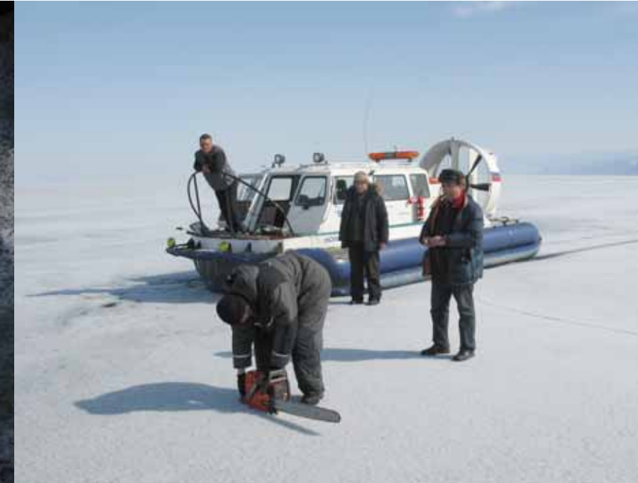
Для обследования льда ученые использовали катер на воздушной подушке «Хиус». Ледовый керн, взятый на расстоянии 2 км от центра кольцевой структуры, оказался весь пронизан микротрещинами. Апрель 2009 г.
